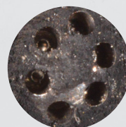
Inyector antes del tratamiento P.i.
